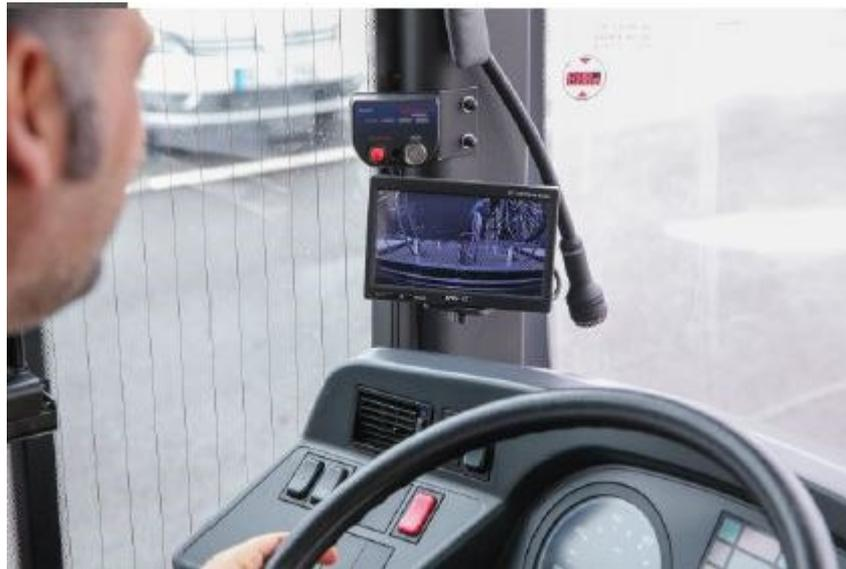
Bild 57: Über eine Kamera kann der Be- und Entladevorgang vom Fahrerplatz überwacht werden. Durch ein Mikrofon können noch Anweisungen gegeben werden [OVR]
