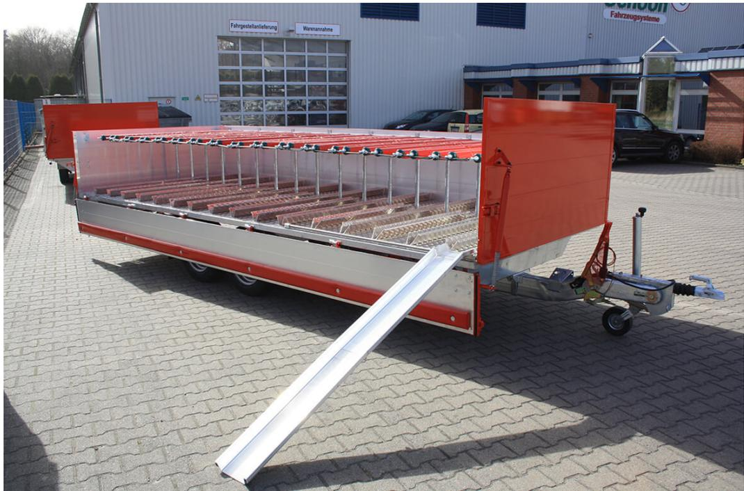
Bild 58: Fahrradanhänger für 20 Fahrräder mit seitlicher Auffahrrampe zum leichten Be- und Entladen [Schoon]
