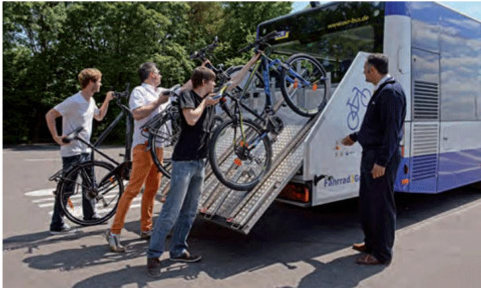
Bild 33: Heckfahrradträger im heruntergeklappten Zustand zur Aufnahme von 5 Fahrrädern [VSS]
