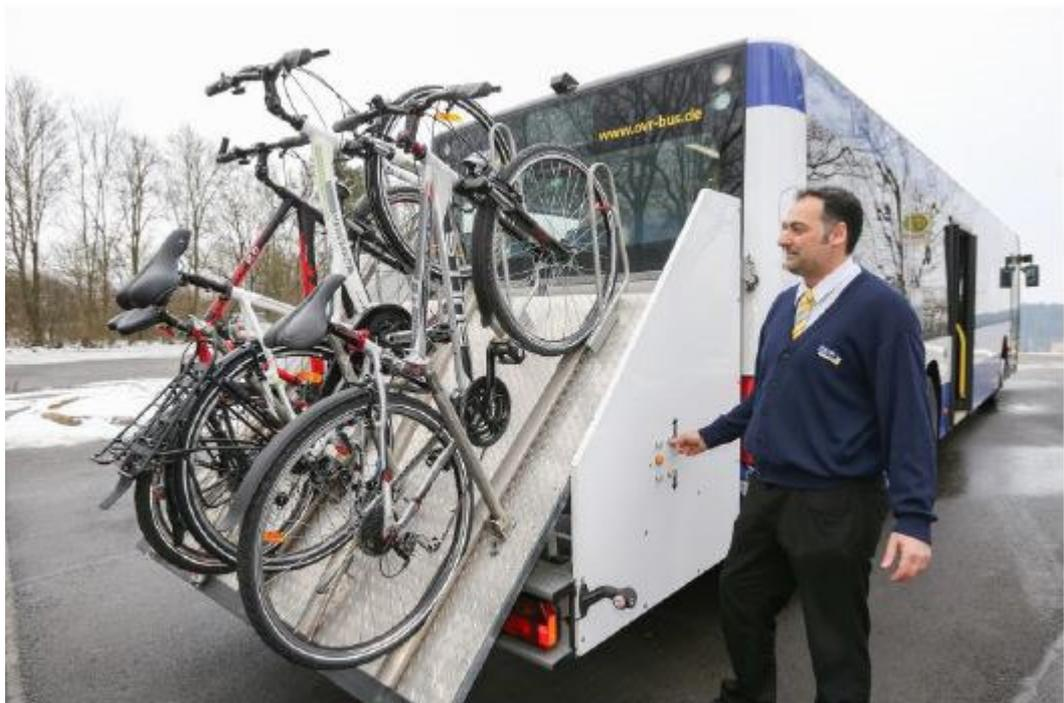
Bild 56: Eigenentwickelte Fahrradplattform am Heck eines Linienbusses im Rahmen des Projekts Fahrrad2go [OVR]
