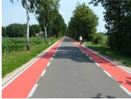
Bild 37: Außerörtlicher Radschutzstreifen, der hier besonders farblich markiert worden ist [Fahrradportal]
