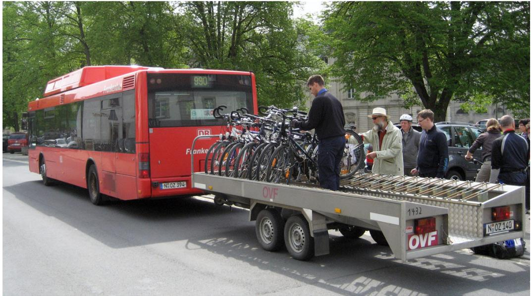
Bild 34: Fahrradanhänger an einem Linienbus. Hier mit Beladung durch den Busfahrer [OVF]
