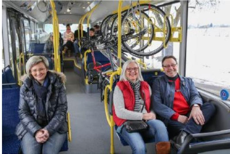
Bild 55: Fahrradmitnahme von 5 Fahrrädern auf der Multifunktionsfläche. Diese kann im Bedarfsfall weiterhin für Rollstühle oder Kinderwagen genutzt werden [OVR]
