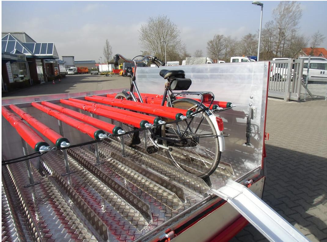
Bild 59: Detail der Befestigung der Fahrräder auf einem Fahrradanhänger [Schoon]
