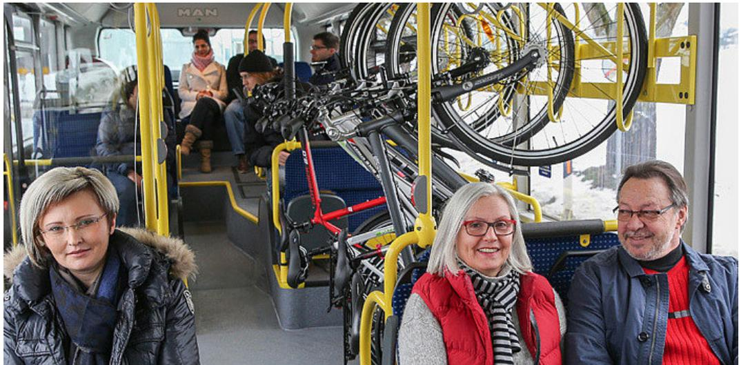
Bild 32: Fahrradmitnahme in spezieller Haltekonstruktion auf der Multifunktionsfläche [NMBW]
